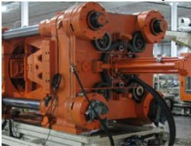
На четвертый день должен быть подсоединен узел впрыска и узел замыкания.
