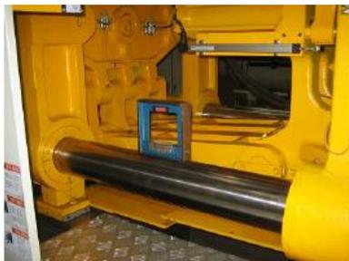
Узел впуска: выравнивание по горизонтали и вертикали должно быть с погрешностью 1000 мм: 0,03 мм.
