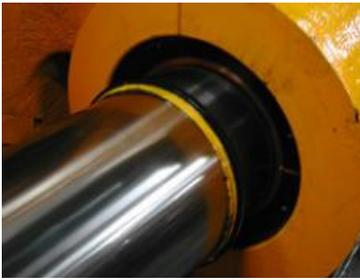
не забудьте установить пылезащитные уплотнения между колоннами и подвижной плитой
