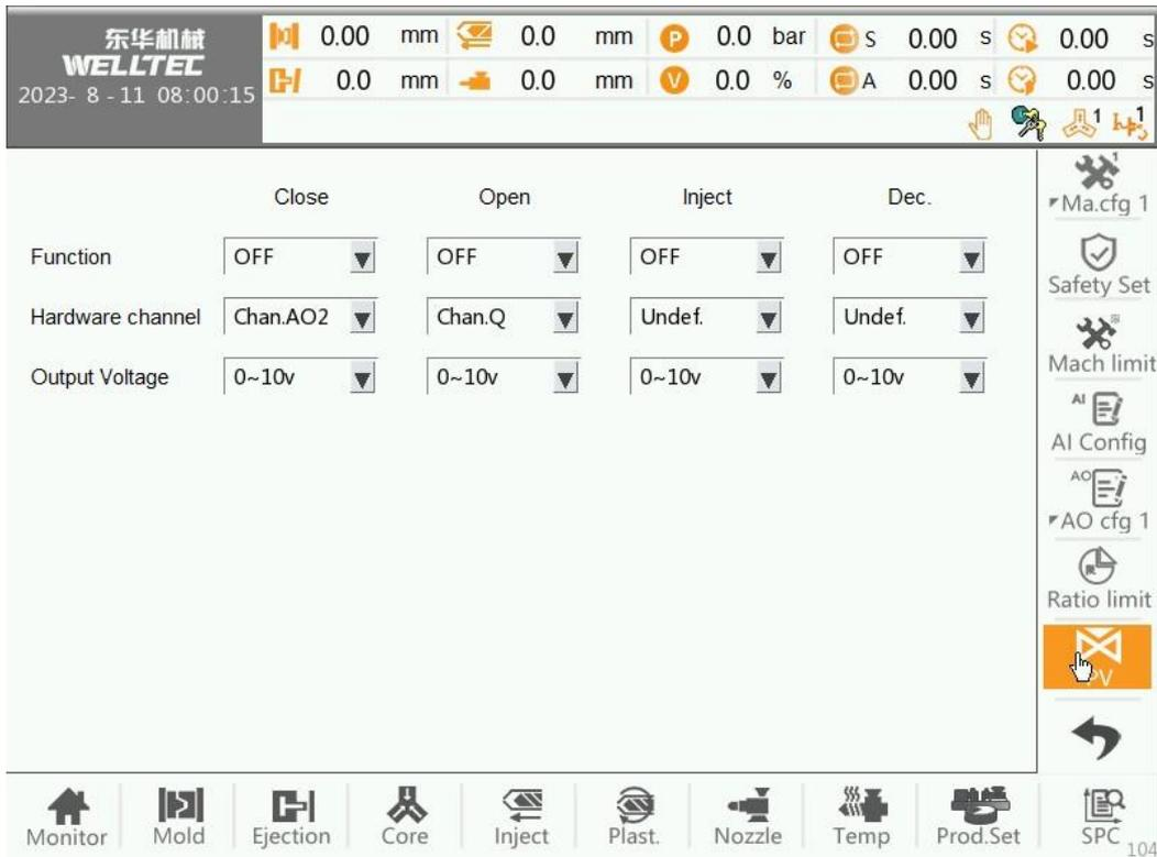
В данном меню в основном настраиваются канал аппаратного обеспечения и тип выходного напряжения пропорционального клапана «смыкание/размыкание» и «впрыск/втягивание».
